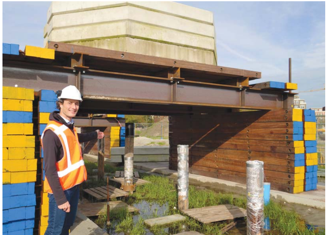
Figuur 3 – Proefopstelling op druk belaste palen conform NPR 7201 klasse A1.
